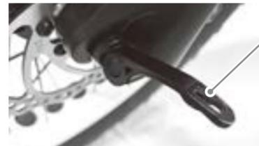
②取り付け部品のレバーを倒して前輪タイヤを、
