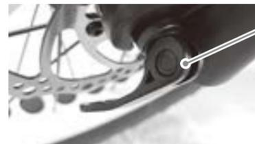
レバーが手で倒せる限界までネジを締める
