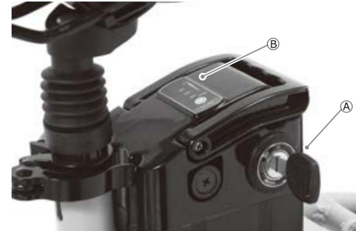
ⒶキーをONにすることで通電します。ONで通電、OFFで通電解除、押し込んで左に回すと自転車への固定解除になります。
